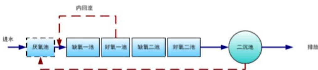
图 3.5-4 改良 bardenpho 工艺流程图
